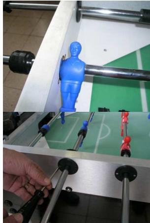
Nun können die Kugellager platziert und die Lagerschalen verschraubt werden.
